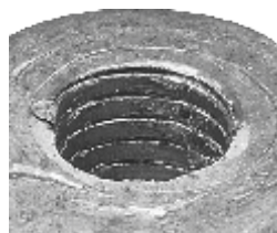
ROSCA DETERIORADA POR EL USO
