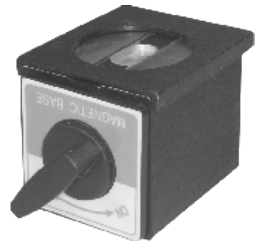
Base magnética chica para el rectificado de pastillas 60x50 mm
