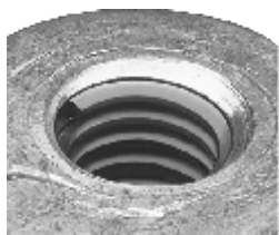
ROSCA REPARADA Y MEJORADA UTILIZANDO INSERTOS HELICOIL
