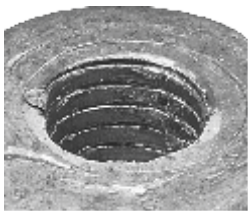
ROSCA DETERIORADA POR EL USO
